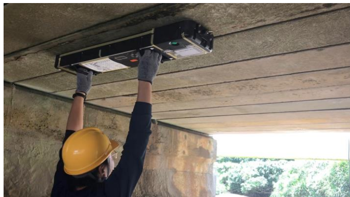
SenrigaNを使った橋梁内部の計測の様子
