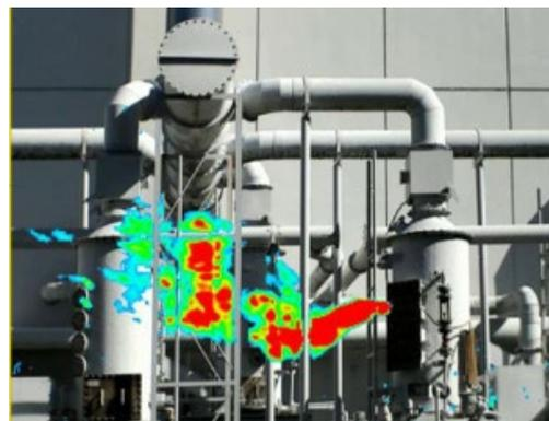
ガス漏洩検査カメラの映像
