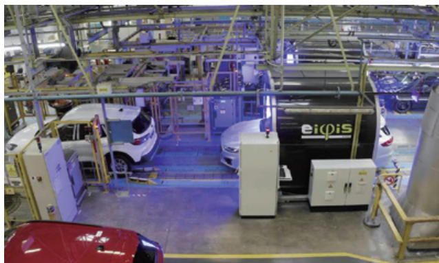
Eines社の自動車生産の品質検査自動化システム
