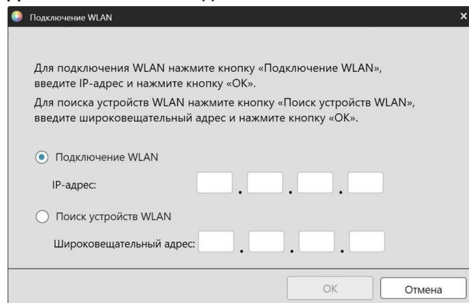
Подключение WLAN Выберите и введите IP-адрес прибора при подключении через AdHoc или через Infrastructure1 с Infrastructure4.
