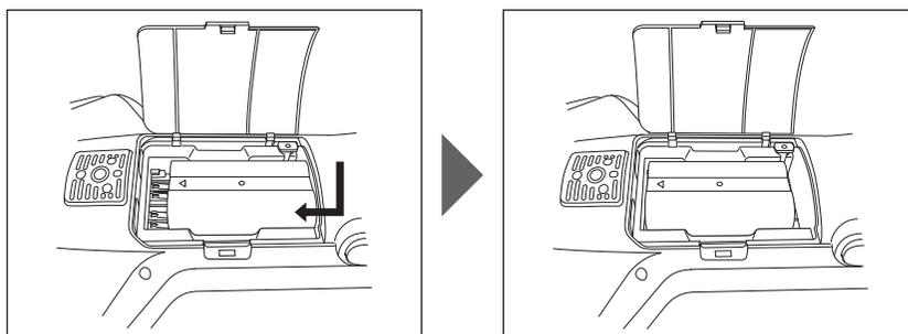
4 Deslice la cubierta del compartimiento de la batería para cerrarlo.
