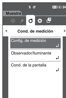
**2 Use [▲] o [▼] para mover el cursor a “Config. de medición” y luego presione la tecla [Confirmación]. Aparece la pantalla <Config. de medición>.**
