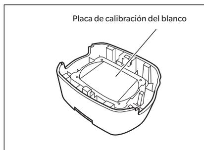
**Notas** Tenga cuidado de no rayar la placa de calibración del blanco y evite que se ensucie. Cuando no esté en uso, asegúrese de que la placa de calibración del blanco quede mirando hacia abajo para evitar que quede expuesta a la luz, y almacénela en la caja rígida (opcional) o tome otras precauciones.
