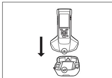
**Memo** Al presionar hasta que se escuche un "clic", un resorte interno presionará la placa de calibración blanca contra el puerto de medición de la muestra, asegurando una calibración correcta.
