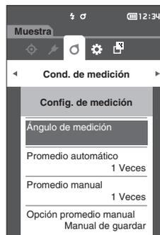
**3 Después de establecer las condiciones de medición, presione el botón [ESC] para volver a la pantalla anterior.**
