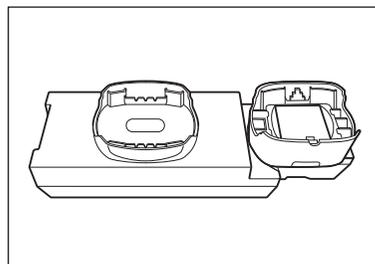
**Notas** Cuando la caja de calibración del cero y la placa de calibración del blanco no estén en uso, manténgalas alejada de la luz externa y del polvo.
