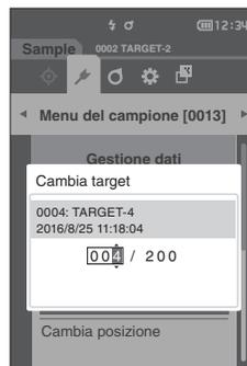
**Note** Se è stato impostato un numero che non risulta assegnato a dati del target per la differenza di colore, il target sarà definito come "Nessuno" e non sarà visualizzata la differenza di colore né la valutazione passa/scarta.
