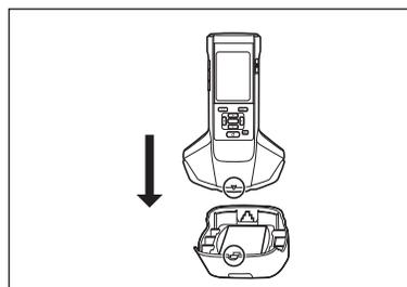
**Promemoria** Premendo fino a quando non si sente un "clic", la piastra di calibrazione del bianco viene spinta contro la porta di misurazione del campione da una molla interna, assicurando una calibrazione corretta.
