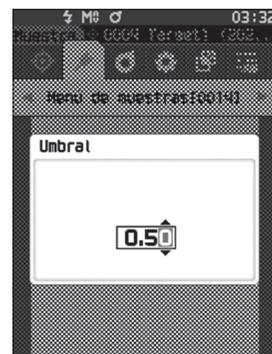
**Notas** Si se presiona [ESC] sin presionar la tecla [Confirmación], no se modificará la configuración y la pantalla regresará a la pantalla <Patrón automático>.
