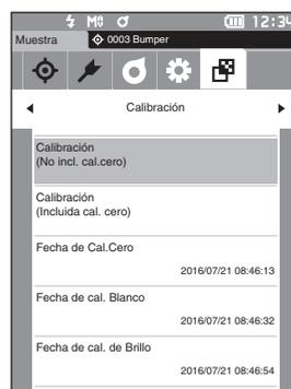
2 Use [▲] o [▼] para mover el cursor a “Calibración (Incluida cal. cero)” y luego presione la tecla [Confirmación].
