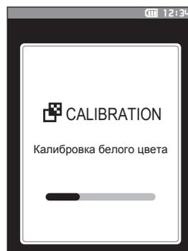
**5 Установите прибор на калибровочный стенд и выполните измерение пластины для калибровки блеска на калибровочном стенде.**
